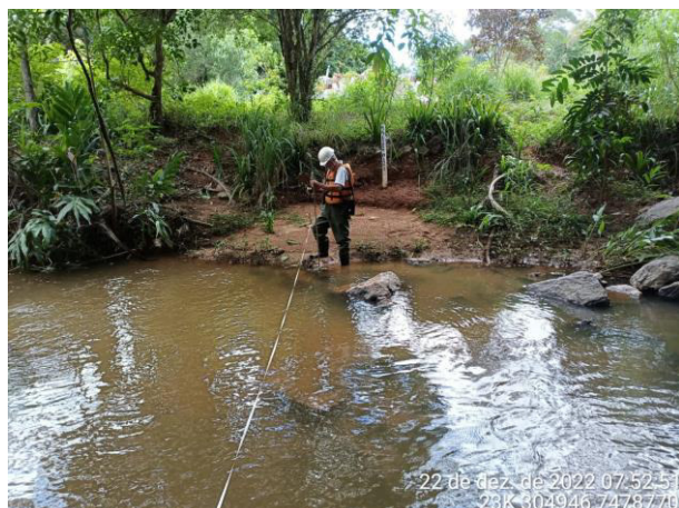
Foto 3.2.1-1. Medição de vazão com molinete fluviométrico no ponto P04, do córrego Entre-Montes.
