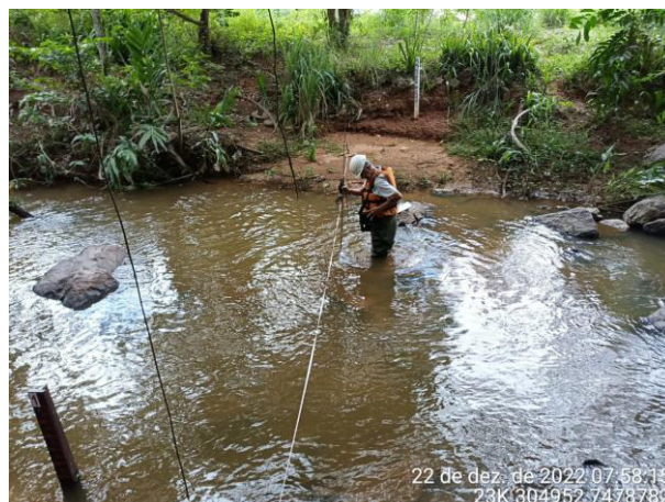
Foto 3.2.1-1. Medição de vazão com molinete fluviométrico no ponto P04, do córrego Entre-Montes.
